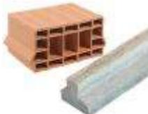
Tutti i solai saranno a struttura latero-cementizia tipo travetti e pignatte e saranno dimensionati e calcolati, in base alle vigenti Leggi, per un sovraccarico accidentale di 250 Kg/mq oltre ai pesi permanenti; H cm 20+4 o quanto deriverà dai calcoli.
